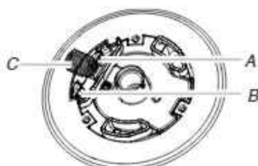
A. Gicleur intérieur B. Gicleur extérieur C. Ressort
