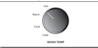
Una vez que haya seleccionado un ciclo, seleccione la temperatura de lavado deseada girando la perilla Wash Temp (Temperatura de lavado) hacia el ajuste apropiado, según la carga. Todos los enjuagues son con agua fría del grifo.
