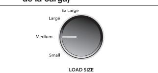
Seleccione el ajuste de Load Size (Tamaño de la carga) más adecuado para su carga. El ajuste para carga Small (Pequeña) agregará una pequeña cantidad de agua para las cargas pequeñas y el ajuste Ex Large (Extra grande) agregará la mayor cantidad de agua para las cargas grandes o voluminosas. Los artículos deben moverse libremente.
