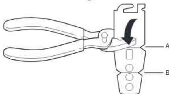
A. Entailler une ligne pour les modèles de cuve en acier inoxydable
