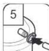
5. Utiliser un tuyau en caoutchouc (non fourni) et une bride à vis (non fournie) pour le raccordement du dispositif de brise-siphon à l'entrée du broyeur à déchets.
