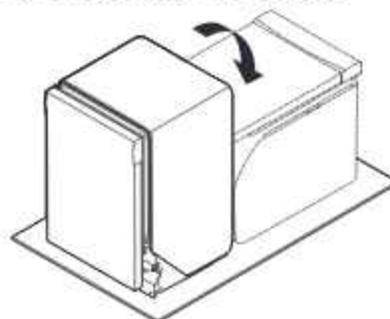
**Conseil utile :** Placer une feuille de carton sous le lave-vaisselle jusqu'à son installation dans l'ouverture d'encastrement de l'armoire pour éviter d'endommager le revêtement de sol.
