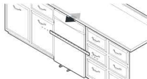
Aligner l'avant du panneau de porte du lave-vaisselle avec les portes des armoires. Il faudra peut-être ajuster l'alignement de celui-ci pour qu'il soit en affleurement avec les armoires.
