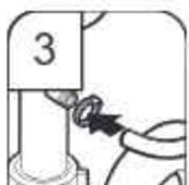
3. Utiliser un tuyau en caoutchouc (non fourni) et une bride à vis (non fournie) pour le raccordement de la canalisation d'égout en T au dispositif de brise-siphon.
