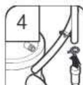
4. Fixer le tuyau d'évacuation sur le dispositif de brise-siphon à l'aide de la grosse bride de tuyau d'évacuation (fournie). À l'aide de pinces, serrer la bride pour l'ouvrir et la mettre en position. Si le tuyau d'évacuation a été coupé, utiliser une bride à vis de 1 1/2 po à 2 po (38 mm à 50 mm) (non fournie).
