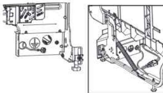
Certains produits sont équipés d'un cordon d'alimentation installé en usine. Pour ces produits, aucun câblage n'est nécessaire lors de l'installation. La connexion entre le fil de terre et le châssis se fait à l'intérieur du boîtier de connexion existant, et le couvercle normal du boîtier de connexion n'est pas inclus.
