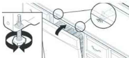
**IMPORTANT :** Vérifier qu'il n'y a aucun contact entre le sommet de la porte et les vis, les brides ou le plan de travail. Si un tel contact se produit, régler le niveau des pattes ou utiliser l'option de fixation sur les côtés.
