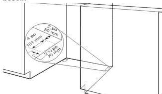
**Surélever le plancher :** Si le plancher de la cuisine est plus élevé que le plancher de l'ouverture de l'armoire (par exemple, le carrelage du plancher de la cuisine n'arrive pas jusque dans l'ouverture de l'armoire), ajouter des cales selon le besoin dans la zone indiquée pour placer le lave-vaisselle à une hauteur maximale de 34 po (864 mm) sous le plan de travail.
