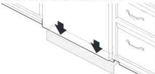
Vérifier que la rive inférieure du panneau d'accès est au contact du plancher. La réajuster au besoin.
