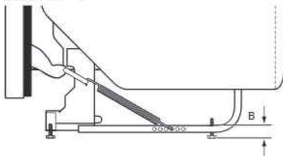
Ajuster les pieds de nivellement avant et arrière à la même hauteur.
