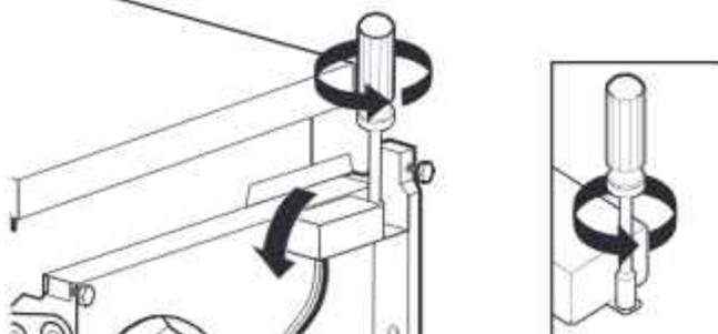
À l'aide d'une clé à douille, d'un tourne-écrou ou d'un tournevis Torx® T20® dont l'embout est de 1/4 po, ôter le couvercle du boîtier de connexion. Le conserver pour utilisation ultérieure.
