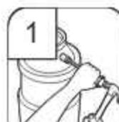
1. À l'aide d'un marteau et d'un tournevis, enfoncer le bouchon d'obturation dans le broyeur à déchets.
