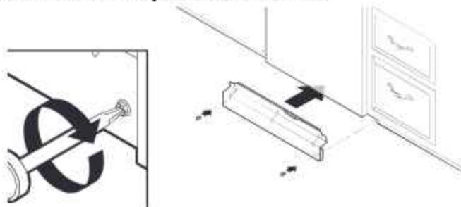
Placer le panneau contre les pieds du lave-vaisselle. À l'aide d'un tournevis à tête cruciforme ou d'un tourne-écrou de 1/4 po, réinstaller les vis à travers les trous du panneau d'accès.
