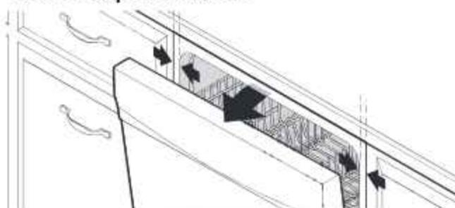
Ouvrir la porte et vérifier que la distance entre l'ouverture de l'armoire pour l'installation du lave-vaisselle et la cuve est la même des deux côtés. Si l'espace n'est pas identique des deux côtés, desserrer les vis des brides d'arrimage et déplacer légèrement la cuve. Resserrer les vis de brides.
