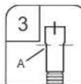
3. Raccorder l'extrémité en caoutchouc (A) du tuyau d'évacuation au dispositif de brise-siphon et couper si nécessaire.
