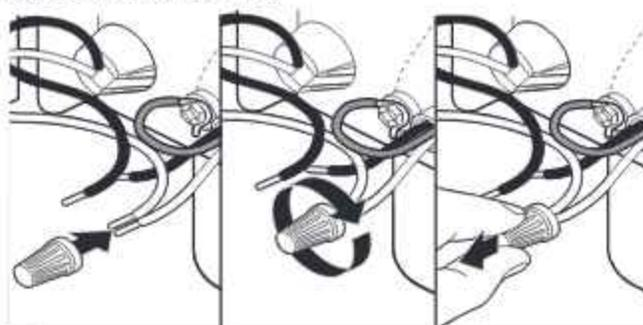
Sélectionner des capuchons de connexion (homologation UL et CSA) de taille correcte. Connecter le conducteur noir avec le noir et le conducteur blanc avec le blanc à l'aide des capuchons de connexion.
