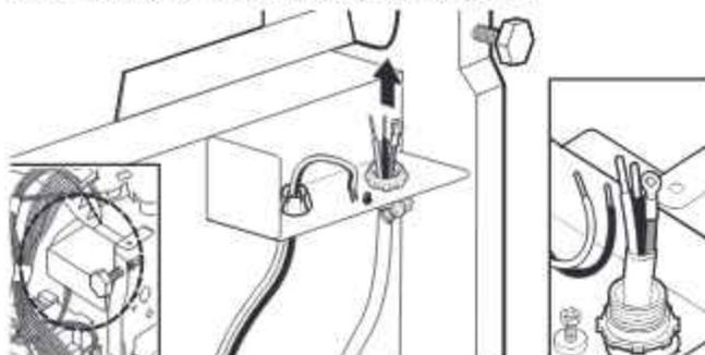
Faire passer le cordon d'alimentation de façon à ce qu'il ne touche ni le moteur du lave-vaisselle ni la partie inférieure de la cuve du lave-vaisselle. Tirer le cordon pour le faire passer à travers le serre-câbles dans le boîtier de connexion.
