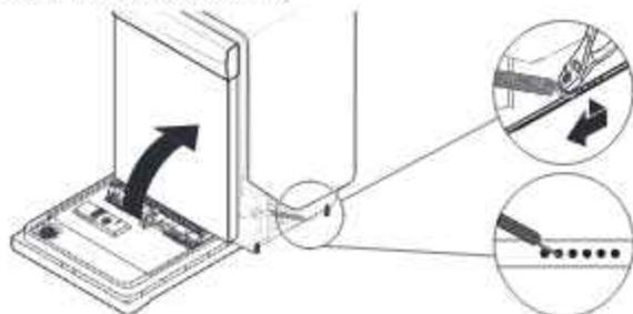
Si la porte se referme trop vite, diminuer la tension des ressorts en déplaçant l'extrémité des ressorts vers l'avant du lave-vaisselle.
