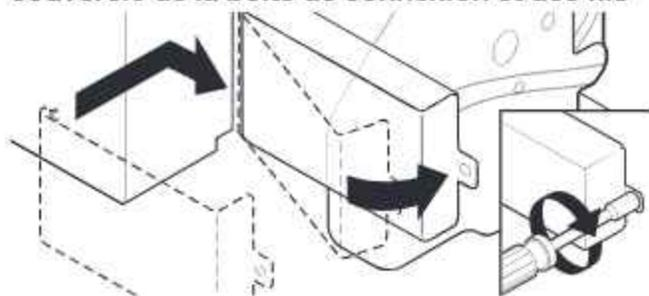
Placer les conducteurs à l'intérieur du boîtier de connexion. Insérer les onglets du côté gauche du couvercle. S'assurer que les fils sont bien logés à l'intérieur du boîtier. Fermer le couvercle tout en veillant à ne pas coincer de fils. Fixer le couvercle à l'aide d'un tourne-écrou ou d'un tournevis Torx® T20® dont l'embout est de 1/4 po et de la vis précédemment retirée.
