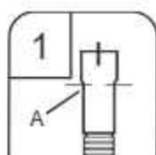
1. Raccorder l'extrémité en caoutchouc (A) du tuyau d'évacuation à la canalisation d'égout en T et couper si nécessaire.
