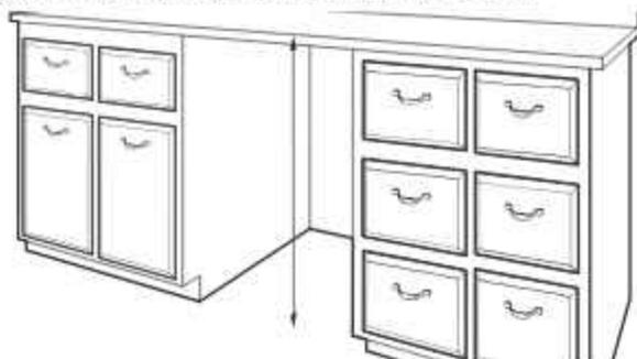
Mesurer la hauteur libre de l'espace d'installation, sous le comptoir. S'assurer de mesurer le point le plus bas sous le comptoir et le point le plus haut sur le sol.
