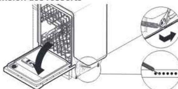
Si la porte s'ouvre d'elle-même, augmenter la tension des ressorts en déplaçant l'extrémité du ressort vers l'arrière du lave-vaisselle.
