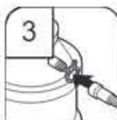
3. Fixer le tuyau d'évacuation sur le raccord de broyeur à déchets à l'aide de la grosse bride de tuyau d'évacuation (fournie). À l'aide de pinces, serrer la bride pour l'ouvrir et la mettre en position.
