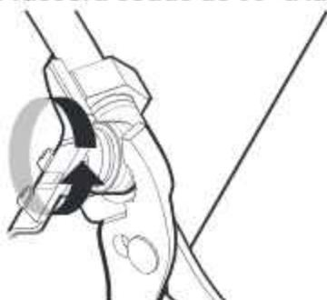
S'assurer que la rondelle de caoutchouc est correctement installée dans le raccord. Enfiler le raccord de 3/4 po (19 mm) du coude à 90° jusqu'au robinet et serrer à la main pour éviter de visser de travers. Serrer à la main jusqu'à ce que le raccord soit serré. À l'aide d'une pince, vérifier l'étanchéité du raccord. Un serrage supplémentaire de 1/4 à 1/2 tour peut être nécessaire pour sceller le joint d'étanchéité en caoutchouc. Passer le tuyau par le côté arrière gauche de l'unité.
