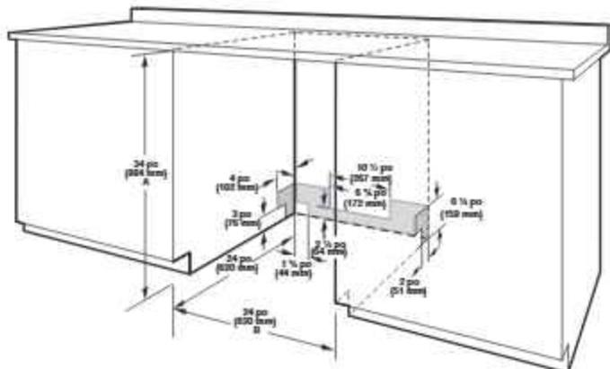
A. Mesure depuis le point le plus bas de la face inférieure du comptoir. Cette dimension peut être réduite à 33 1/2 po (851 mm) en retirant les roulettes du lave-vaisselle et en perforant l'isolant (la plaque d'insonorisation) de l'appareil.
