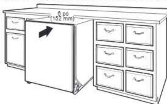
**REMARQUE :** Laisser sortir environ 6 po (152 mm) de l'armoire pour permettre l'installation des supports d'ancrage et régler la tension de la porte au besoin.
