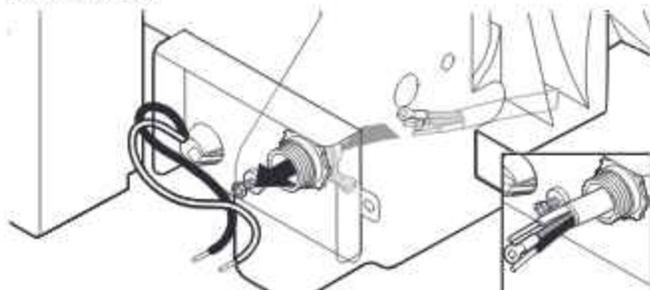
Faire passer le cordon d'alimentation de façon à ce qu'il ne touche ni le moteur du lave-vaisselle ni la partie inférieure de la cuve du lave-vaisselle. Tirer le câble pour le faire passer à travers le serre-câble (homologation UL/CSA) dans le boîtier de connexion. Le serre-câble n'est pas fourni avec le lave-vaisselle. Le propriétaire doit acheter un serre-câble de 7/8 po (22 mm) de type à visser.
