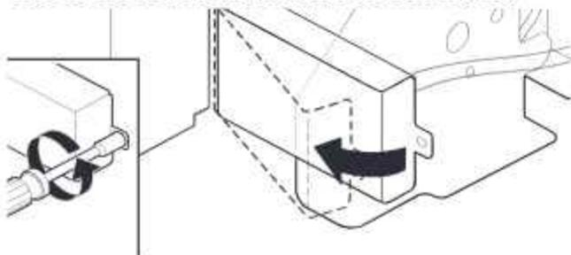
À l'aide d'une clé à douille, d'un tourne-écrou ou d'un tournevis Torx® T20® dont l'embout est de 1/4 po, ôter le couvercle du boîtier de connexion. Le conserver pour utilisation ultérieure.
