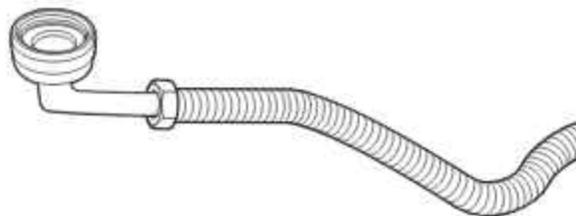
Obtenir le raccord de tuyau coudé à 90° de 3/8 po (9,5 mm) x 3/4 po (19 mm). Voir la section « Outils et pièces » sur la couverture du guide pour des détails sur les pièces et pour commander. Connecter le raccord de tuyau coudé à 90° de 3/8 po (9,5 mm) à l'arrivée d'eau. Le fixer de façon à ce que le raccord de 3/4 po (19 mm) soit orienté vers le haut, tel qu'illustré ci-dessus.
