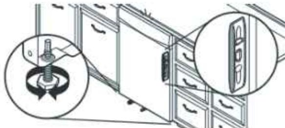
Vérifier que chaque pied de réglage de l'aplomb est fermement en appui sur le sol. Fermer et verrouiller la porte; placer un niveau contre le panneau avant. Vérifier que le lave-vaisselle est centré de l'avant vers l'arrière dans l'ouverture. Si nécessaire, régler le pied de nivellement jusqu'à ce que le lave-vaisselle soit d'aplomb. Répéter ces opérations pour l'autre côté du lave-vaisselle.
