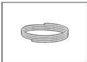
**Tube de cuivre** (diamètre externe de 3/8 po [9,5 mm] suggéré) ou ensemble de canalisation d'arrivée d'eau flexible à tresse d'acier.
