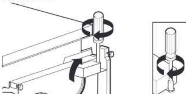
Placer les conducteurs à l'intérieur du boîtier de connexion. Insérer les onglets du côté gauche du couvercle. S'assurer que les câbles sont bien logés à l'intérieur du boîtier et ne sont pas coincés sous le couvercle. Fixer le boîtier de connexion à l'aide d'une clé à douille, d'un tourne-écrou ou d'un tournevis Torx® T20® dont l'embout est de 1/4 po et la vis retirée à l'étape 22.
