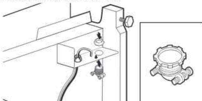
Installer le serre-câbles métallique inclus dans cette trousse (droit : No de pièce Whirlpool 4317824, 90° : No de pièce Whirlpool W10278923RP). S'assurer que les têtes de vis soient orientées vers la gauche lors du serrage de l'écrou à conduit. Un serre-câbles est fourni dans l'ensemble du cordon d'alimentation.
