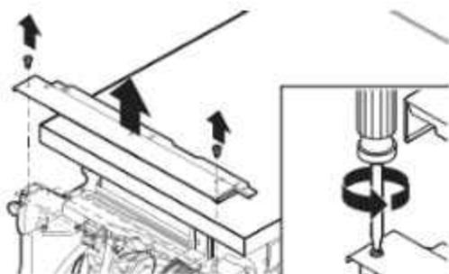
À l'aide d'un tourne-écrou de 1/4 po (6,35 mm) ou un tournevis à tête cruciforme, ôter les deux vis fixant le panneau d'accès au lave-vaisselle.
