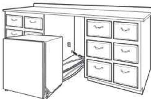
En cas d'utilisation d'un cordon d'alimentation, veiller à acheminer l'extrémité de celui-ci dans le trou de l'ouverture découpée avant de pousser le lave-vaisselle à sa place.
