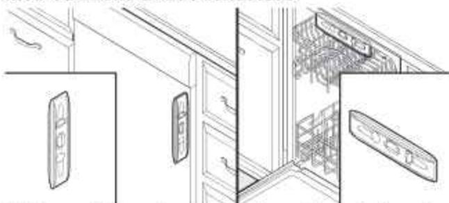
Vérifier que le lave-vaisselle est toujours d'aplomb d'avant en arrière et transversalement dans l'ouverture d'encastrement de l'armoire.
