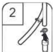
2. Fixer le tuyau d'évacuation sur le dispositif de brise-siphon à l'aide de la grosse bride de tuyau d'évacuation (fournie). À l'aide de pinces, serrer la bride pour l'ouvrir et la mettre en position. Si le tuyau d'évacuation a été coupé, utiliser une bride à vis de 1 1/2 po à 2 po (38 mm à 50 mm) (non fournie).
