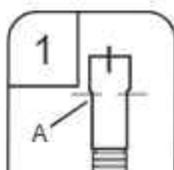
1. Raccorder l'extrémité en caoutchouc (A) du tuyau d'évacuation au dispositif de brise-siphon et couper si nécessaire.
