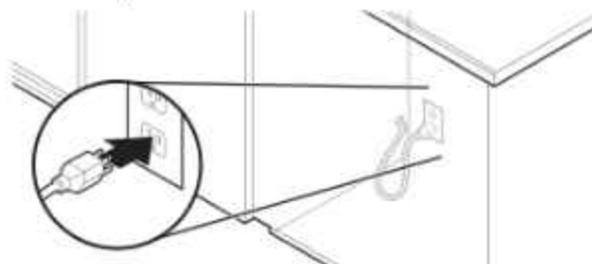
Brancher l'appareil sur une prise à 3 alvéoles reliée à la terre.
