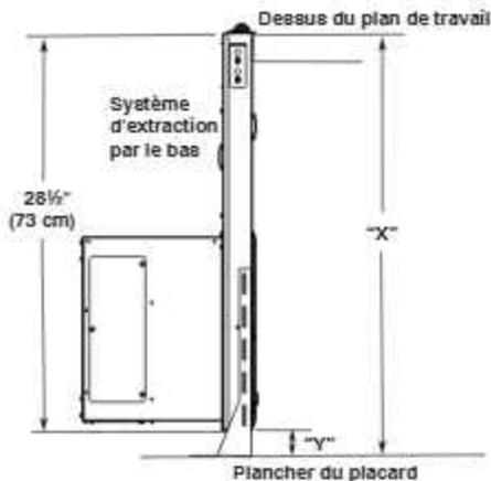
5. Fixer les pieds de soutien aux côtés de la caisse du système d'extraction avec quatre vis de 4 x 8 mm pour chacun. Les régler à la distance "Y" entre le bas de la caisse du système d'extraction et le bas des pieds de soutien. Serrer les vis.
