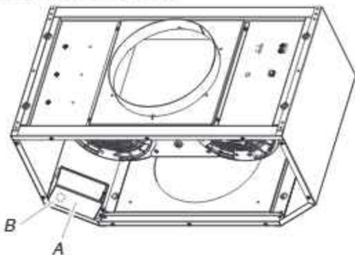
A. Boîtier de connexion électrique
