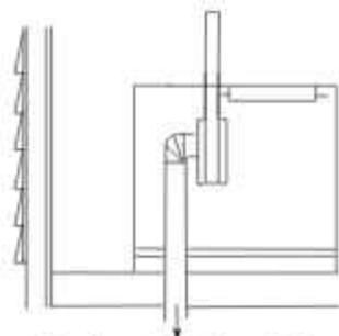
Vers le système de ventilation en ligne installé dans le sous-sol, le vide sanitaire ou le local d'entretien
