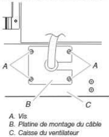
6. En maintenant la platine de montage du câble, sortir l'œillet.
