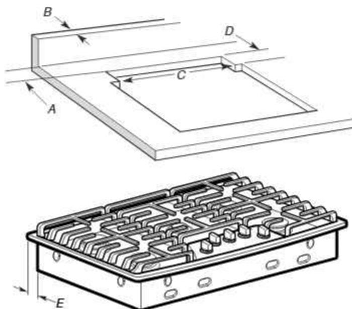
A.  $1/2$ " (13 mm) min. jusqu'au panneau anti-éclaboussure ou mur arrière
