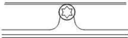
13. Monter le couvercle de 5 1/4" (13,4 cm) (fourni) à l'avant de la caisse du système d'extraction. Placer les encoches en trou de serrure par-dessus les deux vis à épaulement, aligner les trous de montage et fixer le couvercle à la caisse du système d'extraction à l'aide des six vis précédemment retirées du couvercle d'épaisseur 1/4" (6,4 mm).
