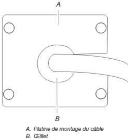
7. Faire glisser le câblage par la fente de la platine de montage du câble pour le retirer.
