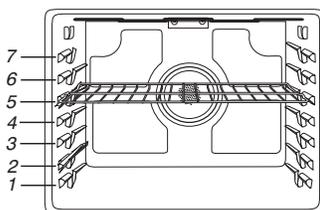
Le four a 7 positions pour une grille plate, comme indiqué dans l'illustration précédente et le tableau suivant.
