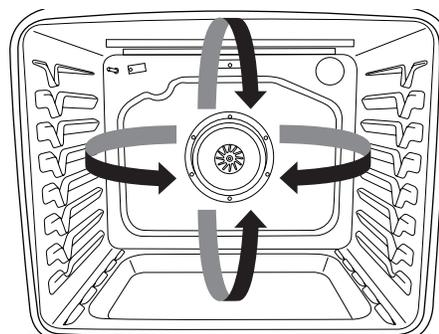
Durant la cuisson par convection, les brûleurs de cuisson au four et de cuisson au grill, et les éléments de convection s'allument et s'éteignent par intermittence pour maintenir la température du four tandis que le ventilateur fait circuler l'air chaud.
