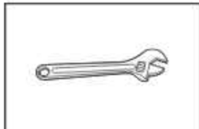
Clé à molette avec ouverture jusqu'à 1 po (25 mm) ou clé à douille hexagonale
