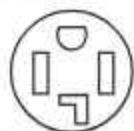
Tomacorriente de 4 hilos (14-30R)
