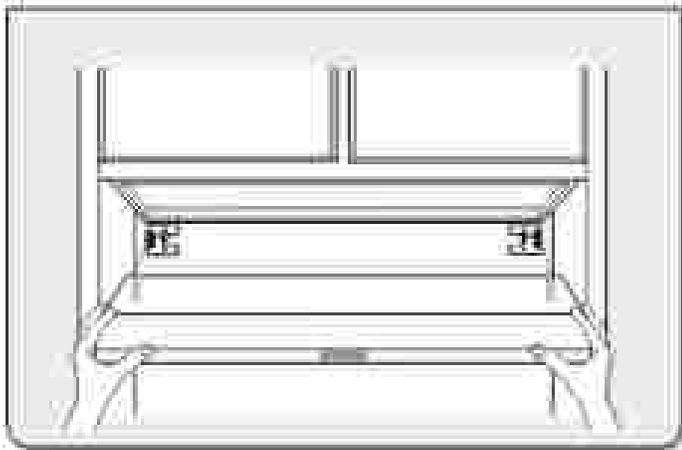
Coulever la hotte et la mettre en place, et insérer les pattes des bricoles de montage dans les tenons situés à l'arrière de la hotte.
