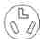
Tomacorriente de 3 hilos (10-30R)
