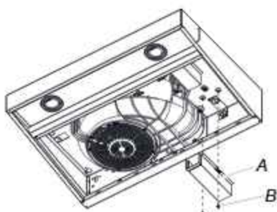
A. Couvercle de la boîte de connexion B. Vis
