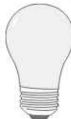
**REMARQUE :** Toutes les ampoules de rechange ne conviennent pas à votre réfrigérateur. Ne pas utiliser d'ampoule à incandescence de plus de 40 watts.
