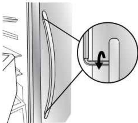
5. Serrer la vis de blocage jusqu'à ce qu'elle commence à toucher la vis d'épaulement en la tournant dans le sens horaire.
