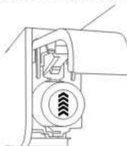
1. Repérer le filtre à eau situé dans le coin supérieur droit du compartiment de réfrigération.
