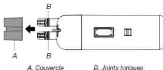
5. Avec la flèche orientée vers le haut, aligner le filtre neuf avec le logement du filtre et le faire glisser pour le mettre en place. La porte du couvercle du filtre entame un mouvement automatique de fermeture à mesure que l'on insère le filtre neuf.
