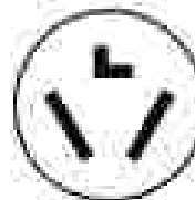
Tomacorriente de 3 hilos (10-30R)
