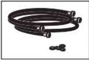
Tuyaux d'arrivée d'eau avec rondelles plates.
