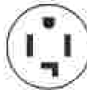
Montaje de 4 hilos (14-30P)
