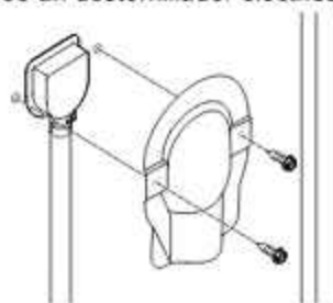
Cubierta de la línea de agua
