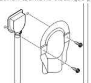
Couvercle de conduite d'eau
